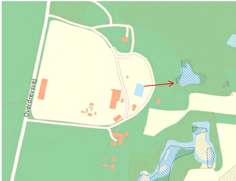
Figur 2-7: Placering af forsinkelsesbassin (lys blå forkant) og markering af spredning af afledt vand over engarealet mod mose og sø med rød pil.
