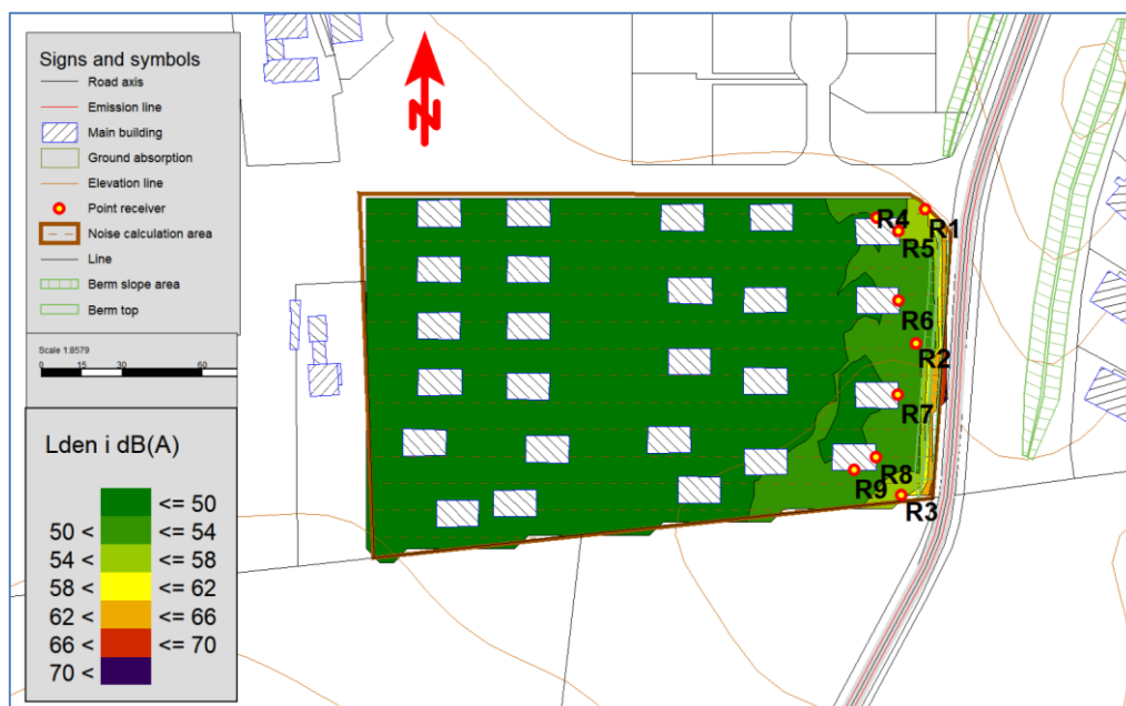
Figur 4 Støjzonekort for L_{den} i 1,5 m højde efter opførelse af 2,0 m høj jordvold
