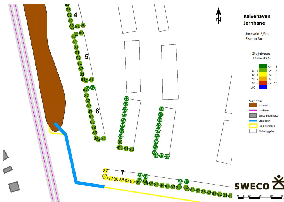
Figur 7: Maksimalstøjniveau L Amax ved udvalgte bygninger sydvest, nærmest Jernbanen
