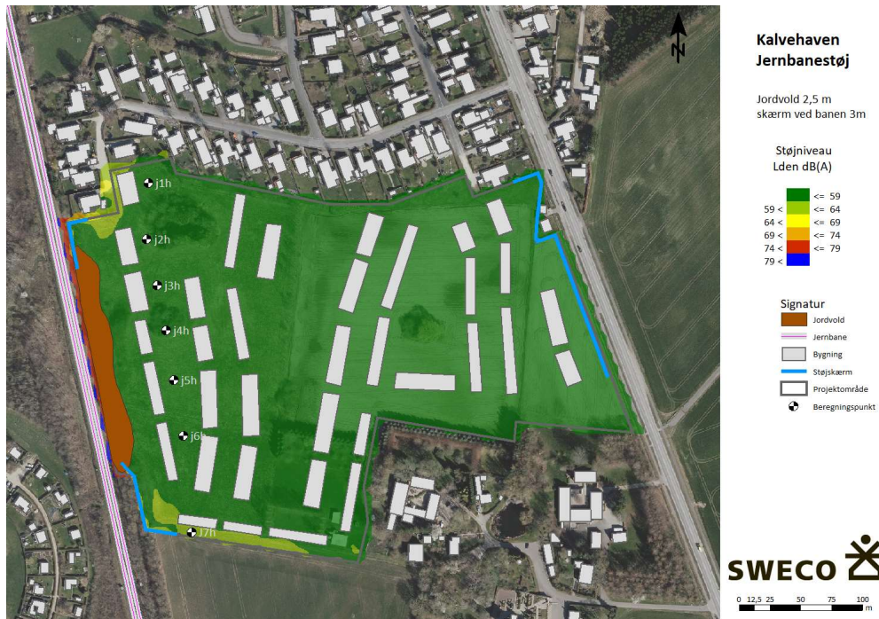
Figur 8: Jernbanestøj. Orienterende beregning af støjkontur for jernbanestøjen. Punkter angiver beregningspunkt for beregnet støjniveau på opholdsarealer i tilknytning til boligerne.
