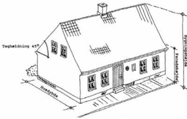
Illustration 1: Husdybde, Facadehøjde, Bygningshøjde og taghældning
