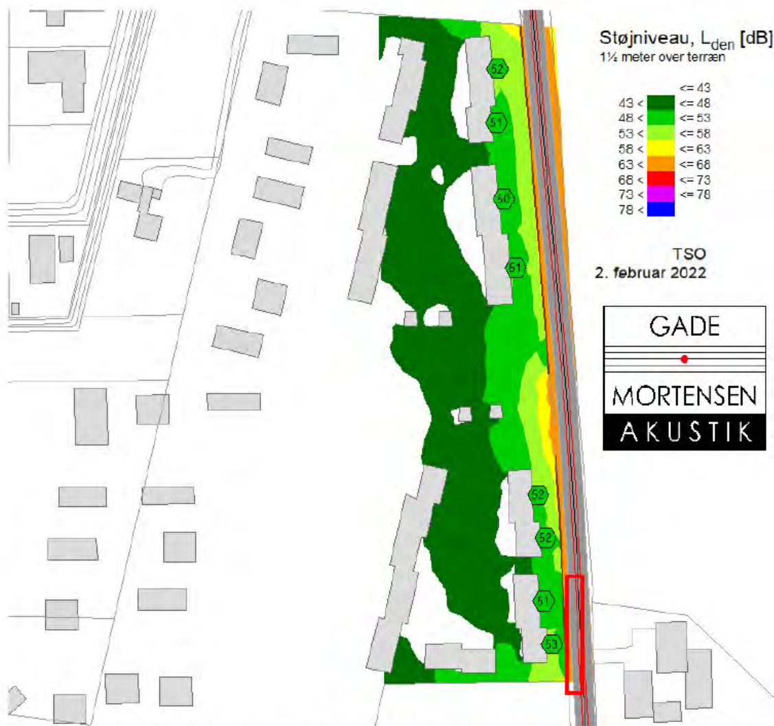
Figur 8: Vejtrafikstøj på boligernes opholdsareal på terræn angivet som L_{den} i dB inkl. refleksion fra "egen" facade (op til 3 dB højere end fritfeltsværdien) med en støjskærm i varierende højde (1,5 – 2,0 meter).
