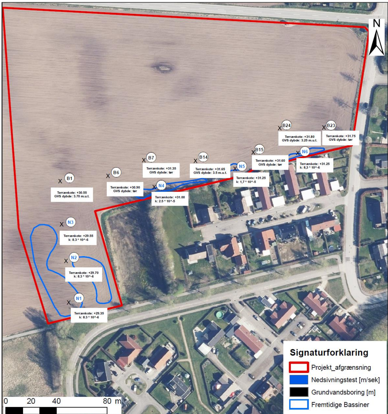
Figur 3-3 Kortet præsenterer resultaterne af de seks udførte infiltrationstests inden for projektområdet som en del af den geotekniske undersøgelse. På dette kort er der også indikeret placeringen af de borer, der er tættest på de planlagte regnvandsbassiner. Disse borer blev benyttet som referencepunkter for at opnå en dybdegående forståelse af jordbundens struktur og højdeprofil i området.
