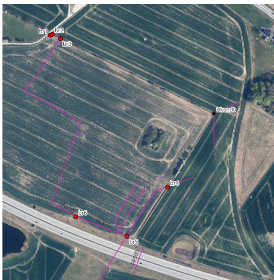
Figur 3 Opmåling af af drænsystemet på Energibyens areal.
