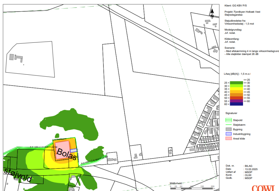
Figur 29 vise støjudbredelse fra virksomhed i det tilfælde at virksomheden skal overholde et støjniveau på 40 dB i skel til nærmeste nabo, samt en støjskærm i skel på 4 meter rundt om virksomheden.
